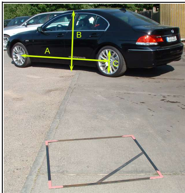
Abb. 3: Vermessung in einer Straßenszene 5 , ermittelte Werte (relativer Fehler bzgl. Ground-Truth-Daten), A : 305,7 cm (2,2 %), B : 152,3 cm (2,2 %), C : 49,4 cm (2,7 %)
