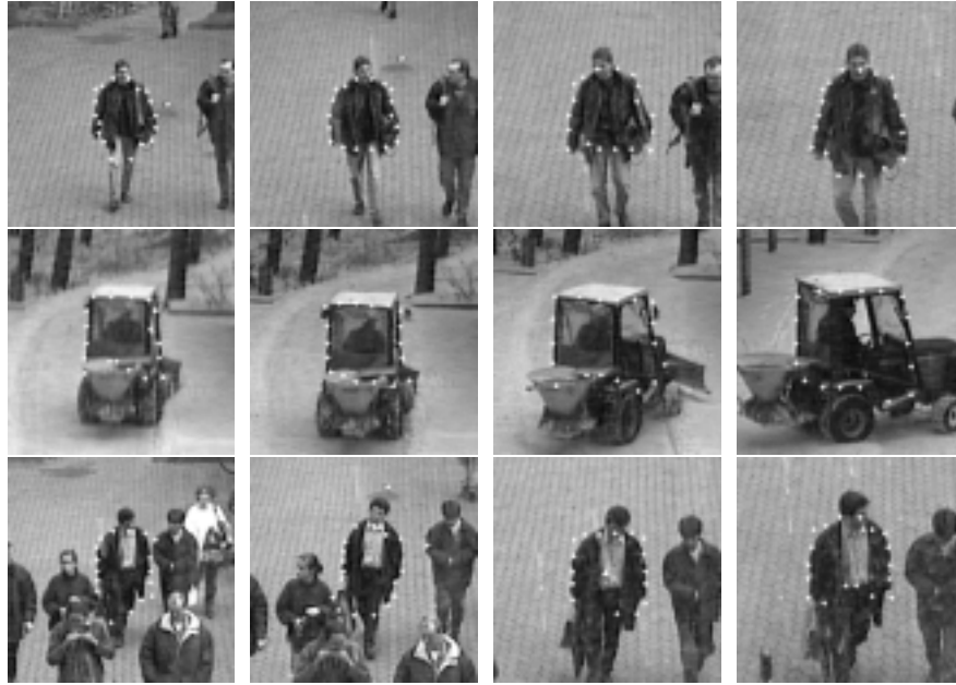
Bild 4. Beispiele der Verfolgung. Die mittlere Zeile verdeutlicht die Auswirkungen des datenbasierten Ansatzes. Auch Personen aus einer Personengruppe können detektiert und verfolgt werden.
