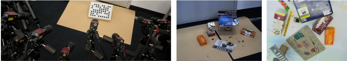
Abb. 1: Aufbau der Experimente, von links nach rechts: Multikamerasystem mit Muster für die Zhang-Kalibrierung, Szene für die Selbstkalibrierung, Szene im ersten Roboterarmexperiment.
