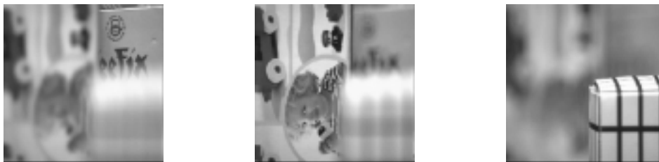
Bild 3: Bilder der komplexen Szene, bei der zur Fokussierung verwendete Bildausschnitt drei Objekte in unterschiedlichen Tiefenbereichen enthält. In den drei Bildern sind Fokusmotorpositionen angefahren, die jeweils ein Objekt scharf abbilden.
